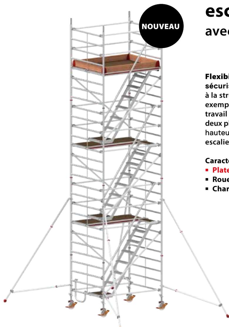
**Flexibilité extrême et montée particulièrement sécurisée :** Utilisable partout et à tout moment grâce à la structure en option avec décalage en hauteur, par exemple en position d'escalier. Avec une surface de travail vaste et spacieuse grâce à la juxtaposition de deux plateformes, quatre roues pivotantes réglables en hauteur. La montée s'effectue en toute sécurité via les escaliers intérieurs.
